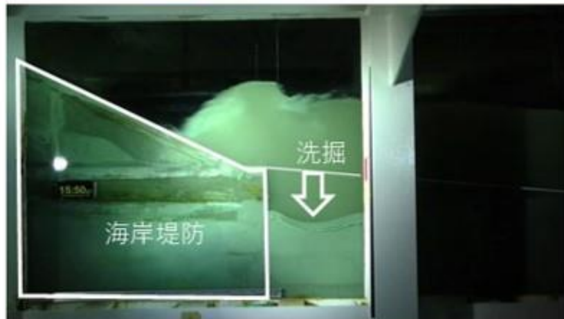
波浪による洗掘深の進行 (大型水理実験)
